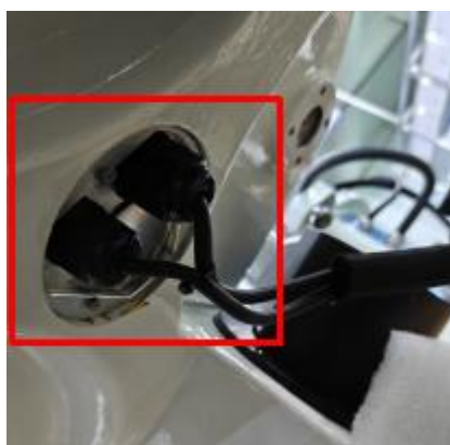
图 6-20 防水接头紧固第四轴电机线缆实物图
