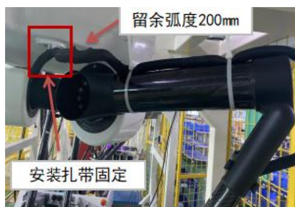
图 6-19 第四轴电机线缆绕基座底部布线实物图
